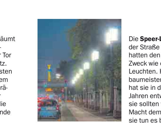
Moderne LED-Leuchten (2014) der Firma Selux im Gleisdreieck-Park zeigen, wie das Berliner Licht in Zukunft aussehen könnte. Die Leuchten richten den Strahl auf das aus, was es sein soll. Wenig Licht strahlt in den Himmel.
