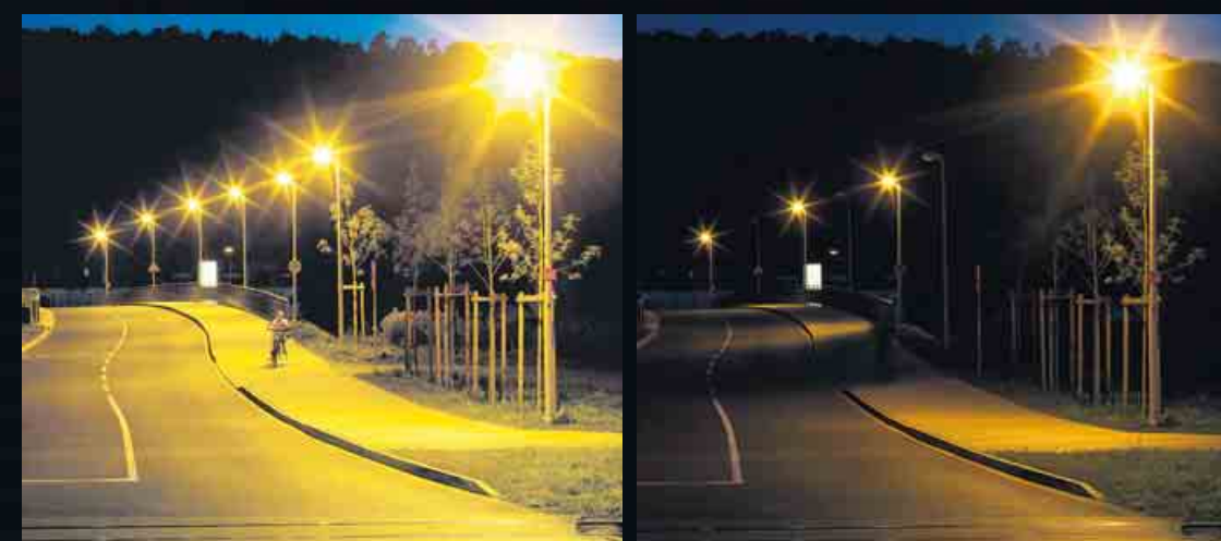
Gutes Licht und schlechtes Licht. Gleichmäßige Ausleuchtung von Wegen ist der Idealfall. Viel öfter gibt es aber schwarze Löcher dazwischen wie auf dem rechten Bild in der vergleichenden Fotostudie der Firma Trilux.
